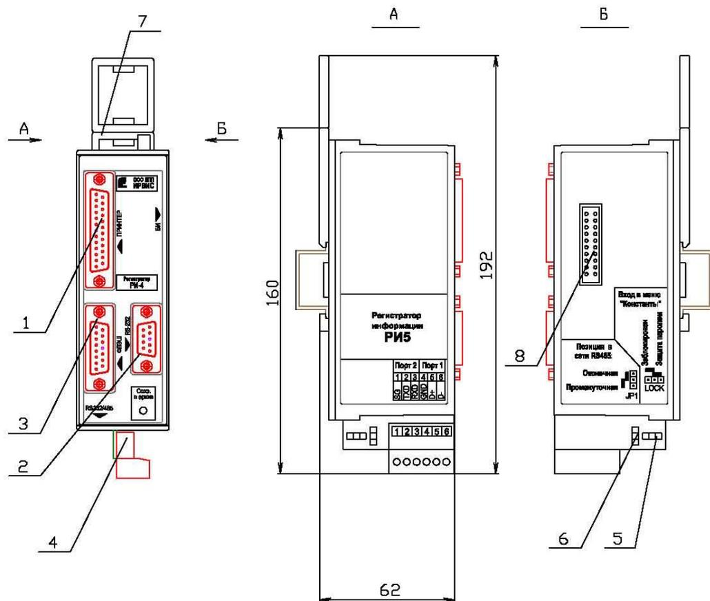
1. Разъем LPT-порта; 2. Разъем для подключения интерфейсного кабеля RS232 к порту 1; 3. Разъем для подключения флэш-носителя; 4. Контактная система для подключения интерфейсных кабелей RS232 к порту 2 и RS485 к порту 1; 5. Штекеры для установки перемычки блокировки меню "Константы"; 6. Штекеры для установки резистора-терминатора в сети RS485; 7. Защелка; 8. Разъем для подключения БИ.
